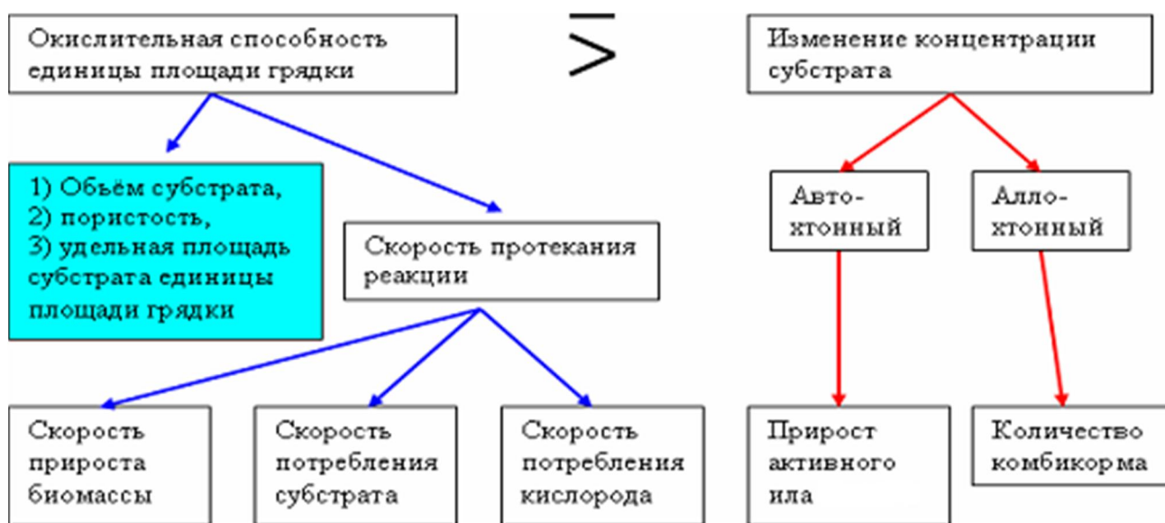
Рис. 2. Балансовая схема взаимодействия водоёма и «плавающей грядки».
